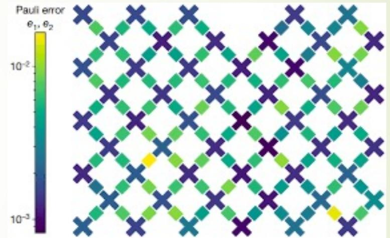
архитектура квантового компьютера Sycamore
